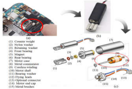
Hình 1.3: Mô-tơ rung cỡ nhỏ: a) Điện thoại di động, b) Mô-tơ rung trong điện thoại di động, c) Sơ đồ lắp ráp [2].
